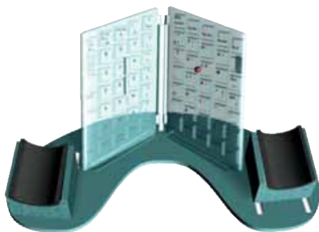
Figuur 1. Ontwerp impressie van het Yogitype toetsenbord vanuit de gebruiker gezien. De polsen rusten in de beweeglijke halfronde kussens. Bij dit doorzichtige ontwerp zijn de toetsen van binnenuit zichtbaar evenals de vingers en handen.
