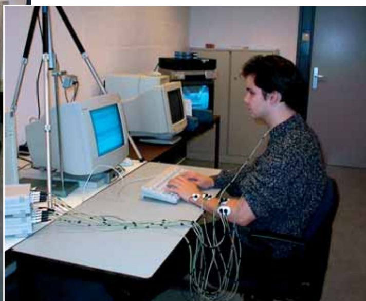
Figuur 3. De werksituatie bij het typen op het standaard horizontale toetsenbord. Eveneens zichtbaar zijn de elektroden en verbindingen die dienen voor het registreren van de EMGs van zes vinger/pols spieren en twee houdingspijeren.
